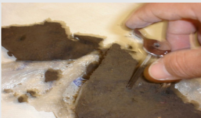
Figura 2. Extracción de muestra para toma de imágenes multiescalares en microscopio SEM
